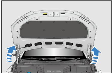
3. 关闭前舱盖：将前舱盖向下拉，双手用力按压前舱盖，使其关闭。
