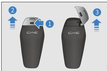
■ 机械钥匙使用完毕，按反方向插入机械钥匙，合上钥匙后盖即可。
