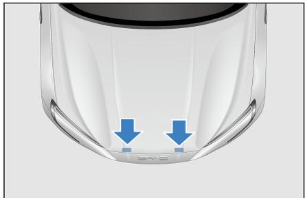
4. 关闭前舱盖后，应检查锁扣是否已被锁定牢固。
