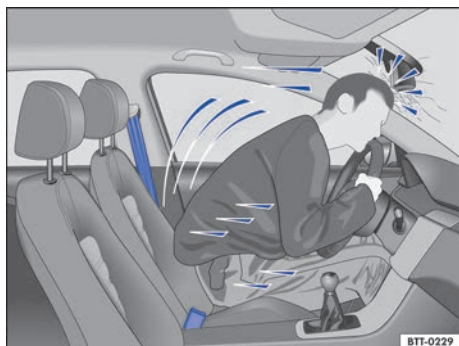
图 19 碰撞时未系安全带的驾驶员被猛烈抛向前方
