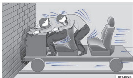
图 18 载有未系安全带的驾乘人员的汽车撞到墙上
