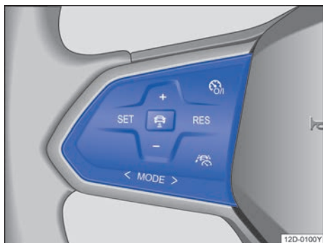
图 113 多功能方向盘左侧：车速限制器操作按钮
