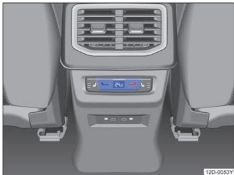
图 104 后部中控台中：用于调节后排座位温度的操作元件
