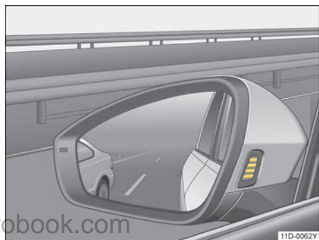
图 123 车外后视镜外壳内：变道辅助系统的可视显示
