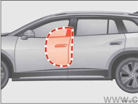
图 29 汽车左侧：侧面安全气囊的膨胀范围
