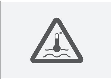
该标识位于动力系统冷却液溢水罐上，用于提示您驱动电机处于过热状态时，不要打开溢水罐盖。否则，灼热的液体和蒸汽会在压力下冲出，发生烫伤事故。
