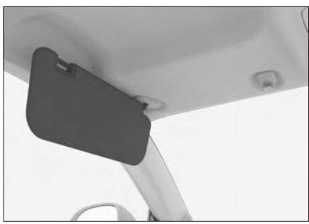
欲遮蔽侧面阳光时，翻下遮阳板，脱开挂钩并转至侧面。
