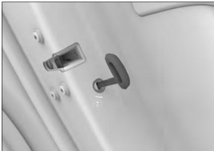
将机械钥匙插入锁孔，按锁孔旁边箭头方向转动钥匙可开启儿童锁，反向转动可关闭儿童锁。
