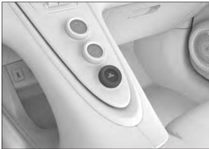
电源模式处于 ON 模式时，旋转驾驶模式切换旋钮，可在标准、经济、运动、女神、个性化之间切换。
