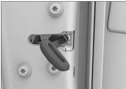
副驾驶员车门和后排车门都配有车门应急锁止装置。
