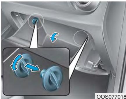
1. 在手套箱打开状态，拆卸手套箱两侧的止动块。
