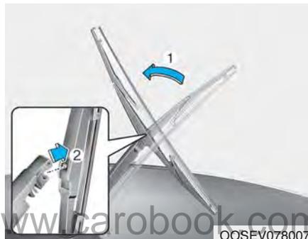
1. 向上提起雨刮器臂，并旋转雨刮器刮片总成 (1)。
