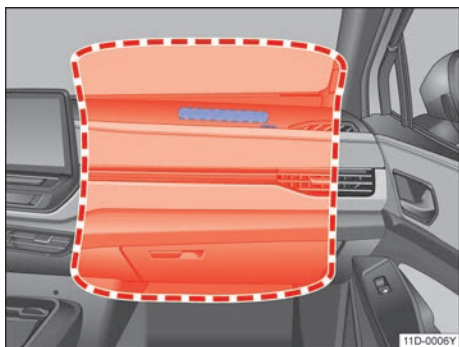
图 28 副驾驶员前部安全气囊的安装位置和膨胀范围
