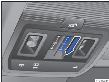
图 86 在顶篷中：关闭遮阳卷帘
