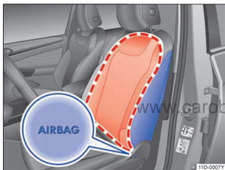
图 30 前排座椅侧面：侧面安全气囊的安装位置和膨胀范围
