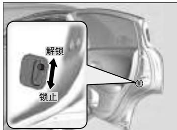
将后车门侧的操作杆滑至锁止位置，然后关闭车门。
