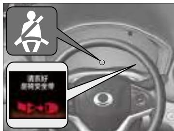
车辆监测前排座椅安全带的使用。系好驾驶员座椅安全带前，如果切换电源模式至 ON，蜂鸣器将鸣响并且指示灯也将闪烁。数秒后，蜂鸣声将会停止，指示灯将持续点亮直至系紧安全带。
