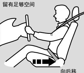
在保持对车辆完全操控的前提下，尽可能向后调节驾驶员座椅。应笔直、靠后坐在座椅上，无需前倾就可完全踩下踏板并舒适地抓握方向盘。应以相似方式调节乘客座椅，让前排乘客尽量远离仪表板上的前气囊。
