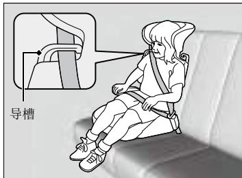
特定儿童安全座椅可用背靠。根据儿童安全座椅制造商的说明，将背靠安装至儿童安全座椅，并根据车辆座椅进行调节。确保安全带正确穿过背靠的肩部导槽，并确保安全带不会触碰及绕过儿童颈部。
