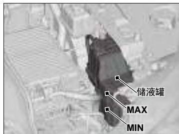
1. 检查储液罐中的冷却液量。
