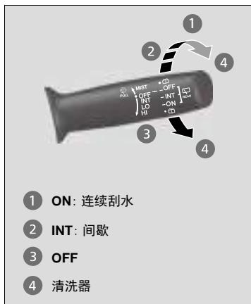
切换电源模式至 ON 位置时，可使用后窗刮水器和清洗器。
