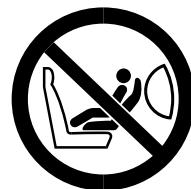
切勿在前面有气囊保护的座椅上采用面朝后儿童保护。
