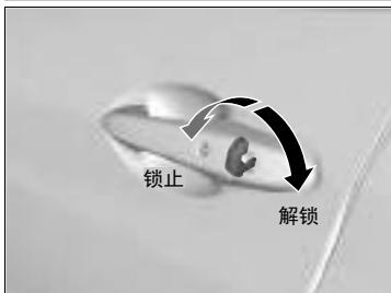
完全插入机械钥匙并按图示方向转动：
