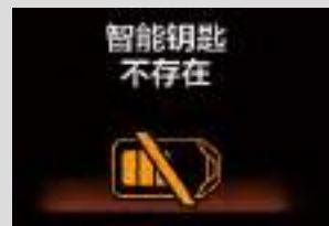
警告蜂鸣器可能会在车内和 / 或车外鸣响，提醒您智能钥匙遥控器在车外。如果在将遥控器放回车内后蜂鸣器继续鸣响，请将遥控器放到操作范围内。
