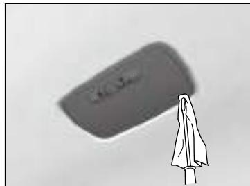
1. 使用平头螺丝刀撬起盖子的边缘，拆下盖子。
