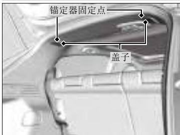
车顶装备有两个用于外侧后排座椅的锚定器固定点。安装有安全带且带有锚定器的儿童保护系统可用锚定器增加安全性。
