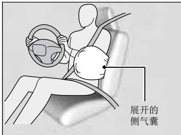
传感器检测到中度至严重侧面碰撞时，控制单元向碰撞侧的侧气囊发出信号以使其立即展开。
