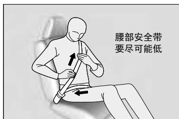
3. 将腰部安全带尽可能低地绕过您的腹部放置，然后向上拉肩部安全带使腰部安全带合适贴身。这可让髋骨卸去车祸的冲击力并减少受内伤的几率。
