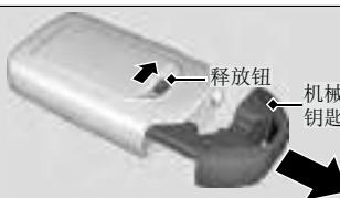
当智能钥匙遥控器电量微弱，遥控锁止 / 解锁车门无效时，内置的机械钥匙可用于锁止 / 解锁车门。若要取下机械钥匙，请拨动释放钮将机械钥匙拉出。若要重新安装机械钥匙，请将机械钥匙推入智能钥匙遥控器直至听到一声咔嗒声。
