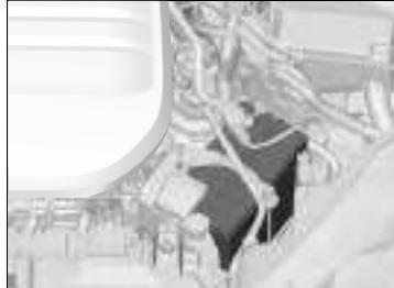
12 伏蓄电池状态由负极端子上的传感器监控。如果传感器出现故障，综合信息显示屏上会出现警告信息。请联系东风本田汽车特约销售服务店检查车辆。
