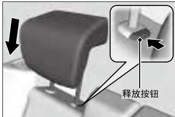
在车辆开始行驶前，坐在后排座椅位置的乘客应将头枕高度调节到合适位置。
