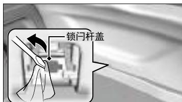
2. 如图所示，用布裹住平头螺丝刀。插入锁闩杆盖并将其打开。
