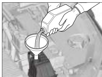
2. 如果冷却液液位在 **MIN** 标记下，添加指定冷却液直至达到 **MAX** 标记。
