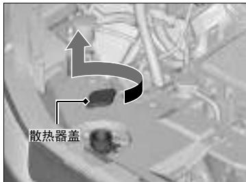
1. 务必等待直至驱动电机和散热器冷却后。
