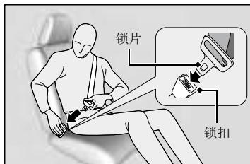
2. 将锁片插入锁扣中，然后用力拉安全带以确保锁扣已紧固。
