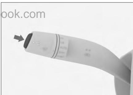
按压顶部洗涤按钮并保持，前雨刮将使用风窗洗涤液刮刷前风窗玻璃，松手洗涤按钮后，雨刮自动回位。
