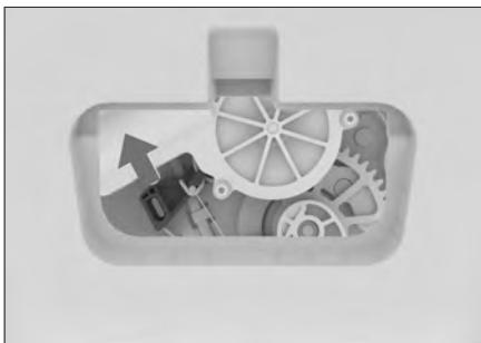
用平头螺丝刀沿图示方向拨动应急开启装置，即可开启后背门。
