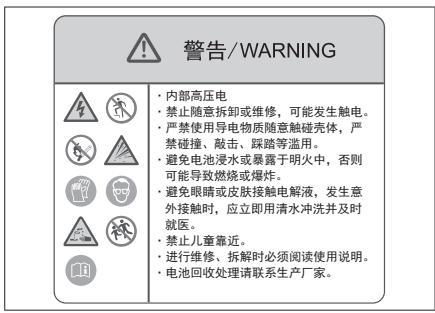
该标贴位于车辆底部的动力电池包上，用于提示您内部为高压电，请注意相关事项。否则，可能会有触电的危险。
