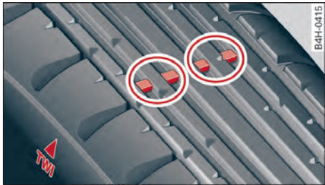
图 172 轮胎花纹：磨损指示
