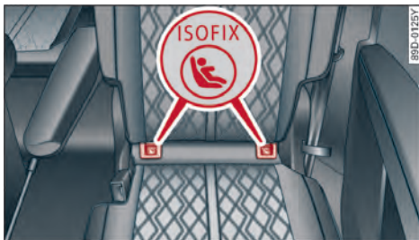
图 82 后排座椅：下面的 ISOFIX 固定座
