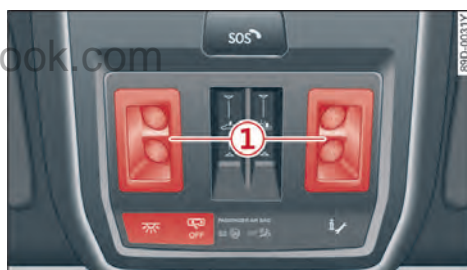
图 40 车顶篷：前部车内照明
