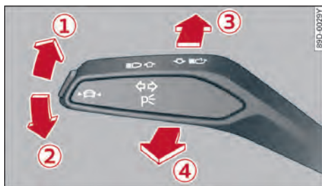
图 38 操纵杆：打开/关闭车灯功能
