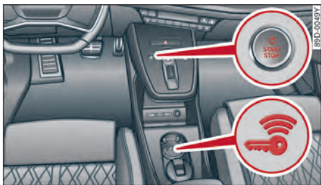
图 97 中控台：启动驱动系统
