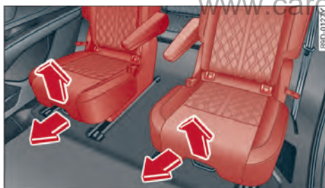
图 54 部分车型调整第二排座椅的前后位置
