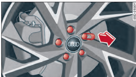
图 176 车轮：车轮螺栓及封盖
