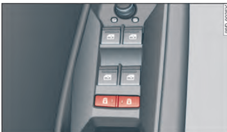
图 34 驾驶员车门: 操控元件
