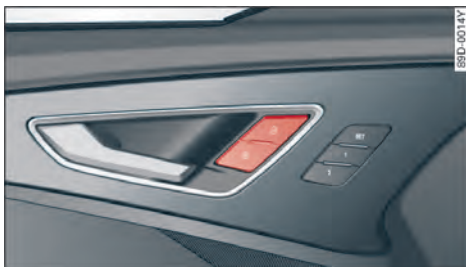
图 23 驾驶员车门：中央门锁开关
