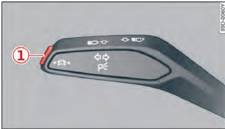
图 121 转向灯操纵杆：车道导航功能按钮
