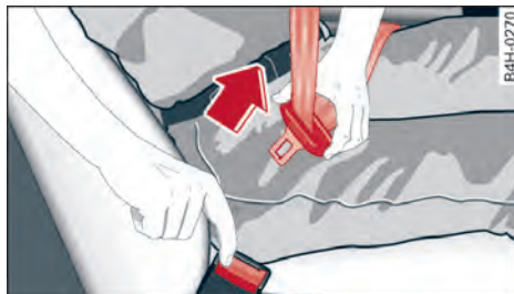
图 78 将锁舌从安全带锁扣中松开
