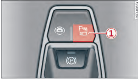
图 110 中控台：驻车辅助系统按钮
