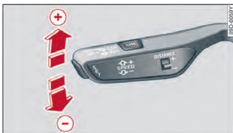
图 120 操纵杆：改变车速
