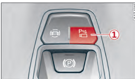
图 133 中控台:驻车辅助系统按钮
