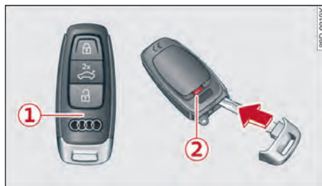
图 28 车辆钥匙：拆卸电池封盖
