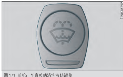
图 171 前舱: 车窗玻璃清洗液储罐盖
