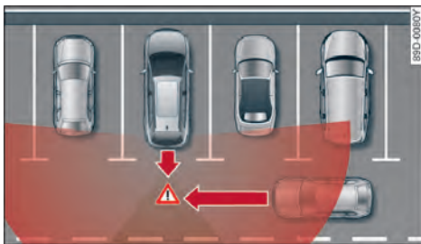
图 139 装有后部交叉车流辅助时的感应器覆盖范围
