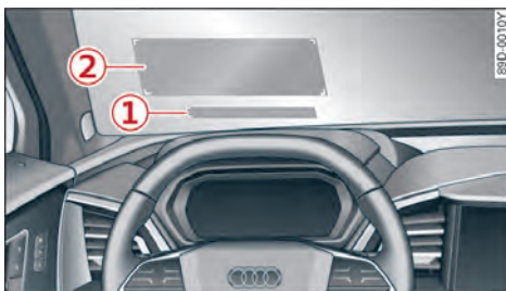
图 19 前挡风玻璃：平视显示的显示部位
