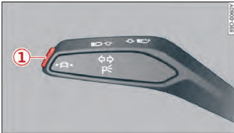
图 129 转向灯操纵杆：车道导航功能和车道偏离警告功能按钮
