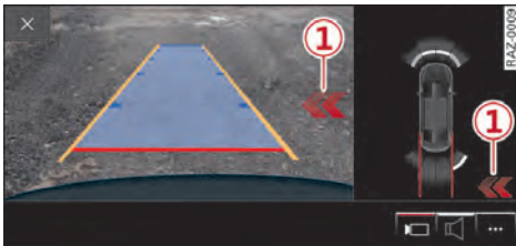
图 140 中间显示屏：后部交叉车流辅助的显示
