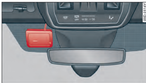
图 112 前风窗玻璃上：电子道路收费系统的车载单元
