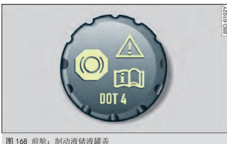
图 168 前舱：制动液储液罐盖
