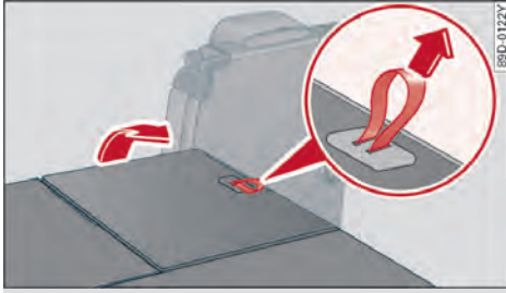
图 59 第三排座椅：翻回后座椅
