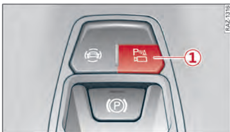
图 136 中控台：驻车辅助系统按钮
