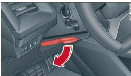
图 71 转向柱：方向盘位置的调节操纵杆
