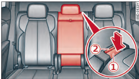
图 89 中间靠背：解锁操纵杆和带红色标记的安全指示器
