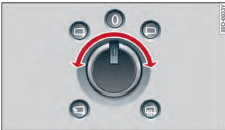
图 42 驾驶员车门：车外后视镜旋钮
