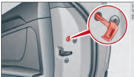
图 25 车门：给车门应急上锁
