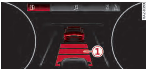
图 125 组合仪表盘：要求驾驶员接管驾驶操控
