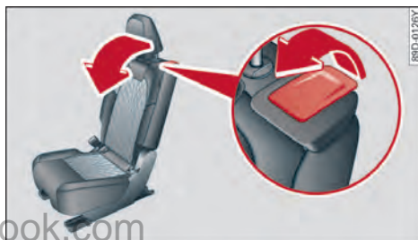
图 55 第二排座椅：上车辅助功能的操作杆
