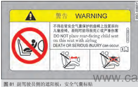
图 81 副驾驶侧的遮阳板：安全气囊标识
