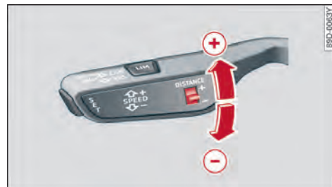
图 122 操作杆：设定车距
