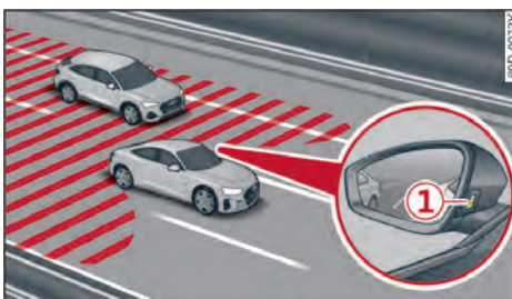
图 131 驾驶情形和外后视镜上的显示
