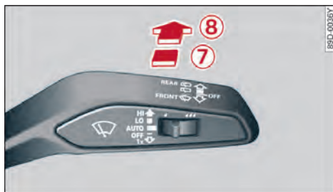
图45 操纵杆:后窗雨刮器
