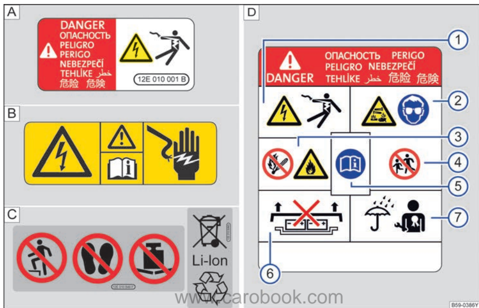
图 108 警告牌（示意图）：A 高压组件，B 高压电普通警告牌，C、D 高压蓄电池上的警告牌
