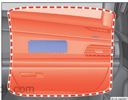
图 33 副驾驶前部安全气囊的安装位置和膨胀范围
