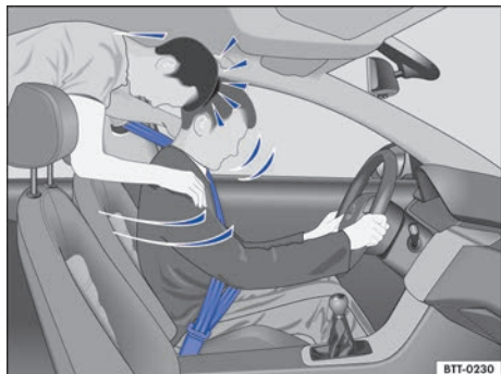
图 25 未系安全带的后排乘员被猛烈前抛，撞击佩戴安全带的驾驶员
