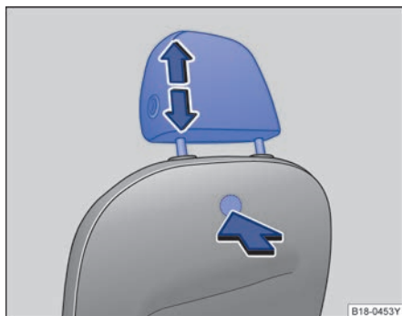
图 61 拆卸和安装前排头枕
